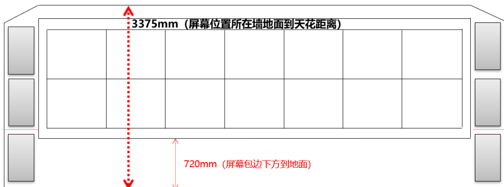
原有背投显示屏墙体立面示意图
